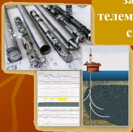
Приборы, предназначенные для определения ориентации буров при бурении скважин для добычи нефти и газа называются инклинометры
